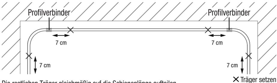
Die restlichen Träger gleichmäßig auf die Schienenlänge aufteilen.
