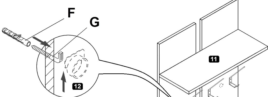
**D** Das beigegebue Wandbefestigungsmaterial (Dübel und Schrauben) eignet sich nur für festes Mauerwerk (z.B. Beton- oder Ziegelwände). Für andere Wandaufbauten sind eventuell Spezialdübel und andere Schrauben notwendig. Ziehen Sie gegebenenfalls eine Fachkraft zurate.
