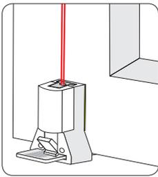
Klebestreifen vom Klemmträger oben entfernen und den Träger durch Einrasten der Klemmschiene und festen Druck am Fensterrahmen fixieren. Danach ebenso mit den Klemmträgern unten verfahren. Nach fertiger Montage allen Klemmträgern die Abdeckhaube aufschieben.
