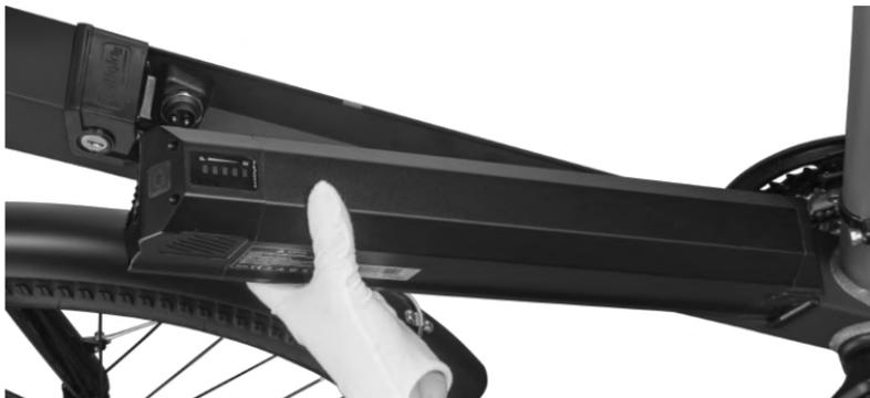
Gehen Sie in umgekehrter Reihenfolge vor, um die Batterie zu entfernen.
