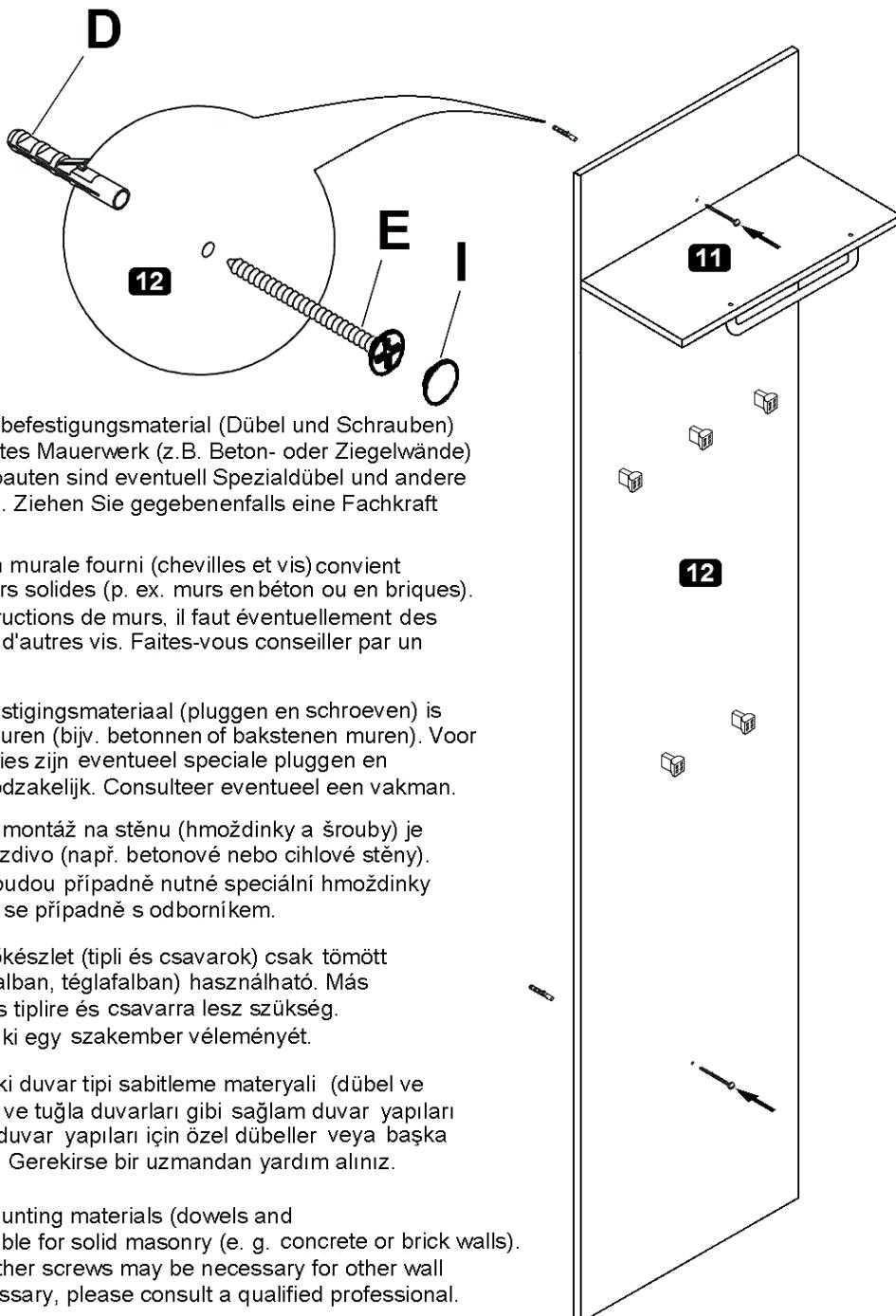
**D** Das beigelegte Wandbefestigungsmaterial (Dübel und Schrauben) eignet sich nur für festes Mauerwerk (z.B. Beton- oder Ziegelwände). Für andere Wandaufbauten sind eventuell Spezialdübel und andere Schrauben notwendig. Ziehen Sie gegebenenfalls eine Fachkraft zurate.
