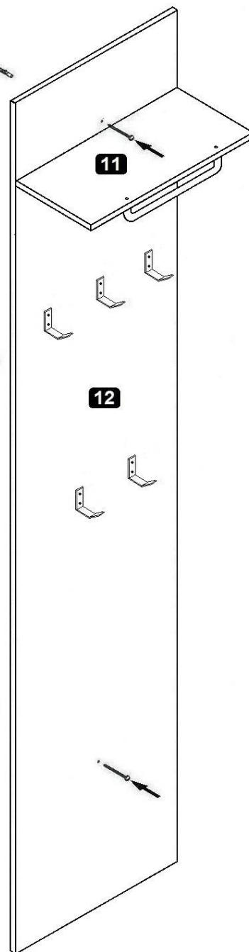
**D** Das beigegebte Wandbefestigungsmaterial (Dübel und Schrauben) eignet sich nur für festes Mauerwerk (z.B. Beton- oder Ziegelwände). Für andere Wandaufbauten sind eventuell Spezialdübel und andere Schrauben notwendig. Ziehen Sie gegebenenfalls eine Fachkraft zurate.
