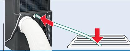
Bei Bedarf Kondenswasserschlauch anbringen
