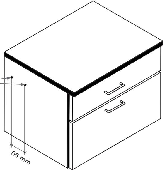
Die Position des Handtuchhalters ist frei wählbar. Beachten Sie beim bohren innenliegende Bauteile.
