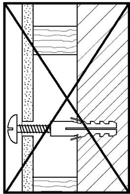
**HU** A mellékelt fali rögzítőkészlet (tippli és csavarok) csak tömött falazatban (pl. betonfalban, téglafalban) használható. Más faltípusokhoz speciális tipplire és csavarra lesz szükség. Szükség esetén kérje ki egy szakember véleményét.
