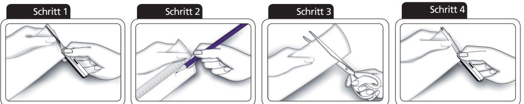
**Schritt 1:** Den Lamellenhalter aus der Lamelle ziehen. Den Saum entfalten und das Kunststoffstäbchen entfernen.
