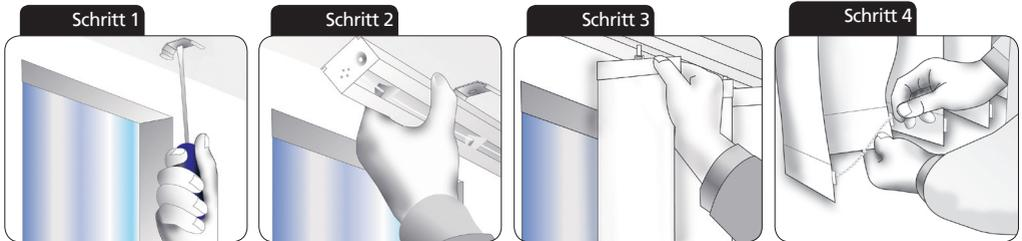
**Schritt 1:** Den ersten Clips an der Bedienseite ca. 15 cm von der Schienenaußenkante setzen. Alle weiteren Clips ca. alle 80 cm montieren. Messen Sie von der Wand ausgehend die Bohrstellen aus (Schiennenmitte). Achten Sie auf genügend Abstand der Lamellen zur Wand. Die mitgelieferten Clips haben ein Langloch und lassen eine Korrektur bis zu 5 mm zu. Schrauben Sie die Clips an.
